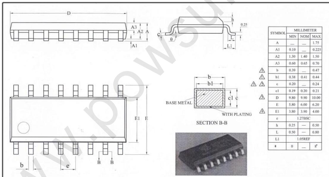
图 1-14 SOP16 封装 POD 图
