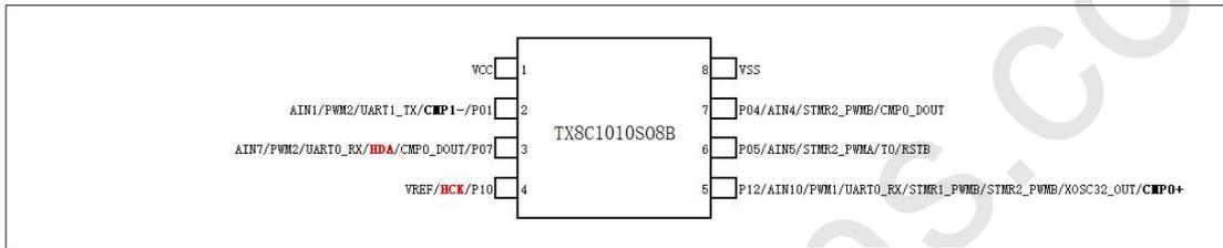
图 1-1 TX8C1010S08B（SOP8）引脚图
