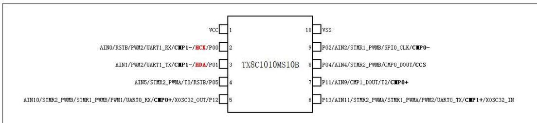
图 1-4 TX8C1010MS10B (MSOP10) 引脚图
