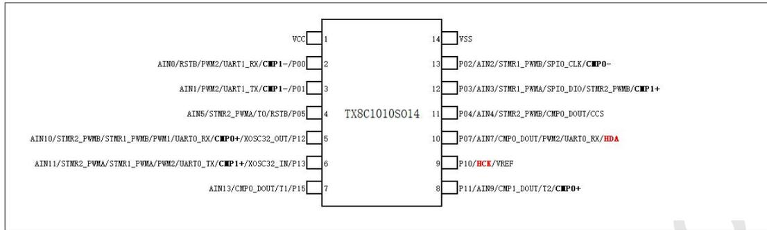
图 1-5 TX8C1010S014 (SOP14) 引脚图
