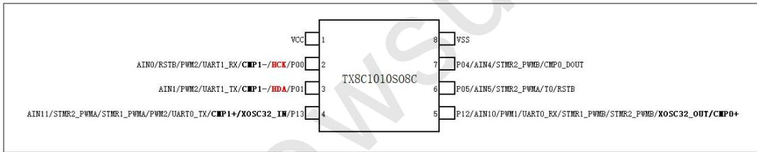
图 1-2 TX8C1010S08C（SOP8）引脚图
