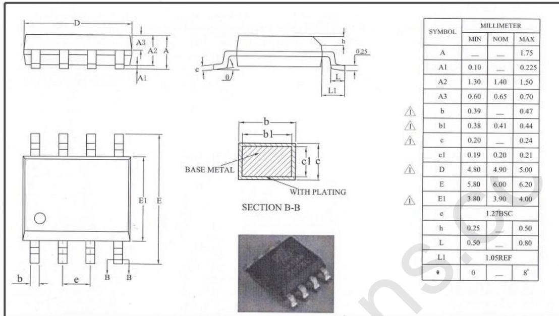
图 1-11 SOP8 封装 POD 图
