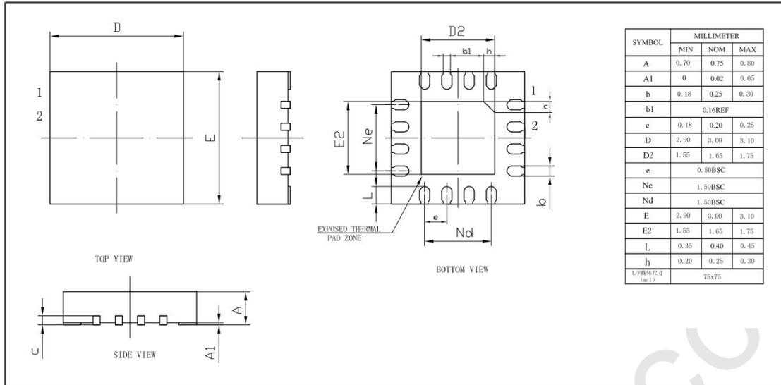
图 1-15 QFN16 封装 POD 图
