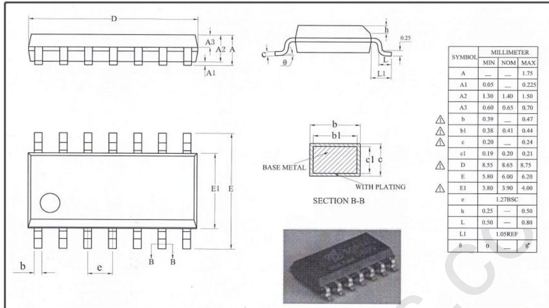
图 1-13 SOP14 封装 POD 图
