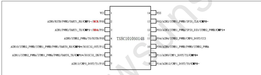
图 1-6 TX8C1010S014B (SOP14) 引脚图
