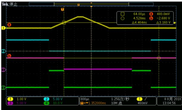
图6 ITRIP 输入阈值电压
