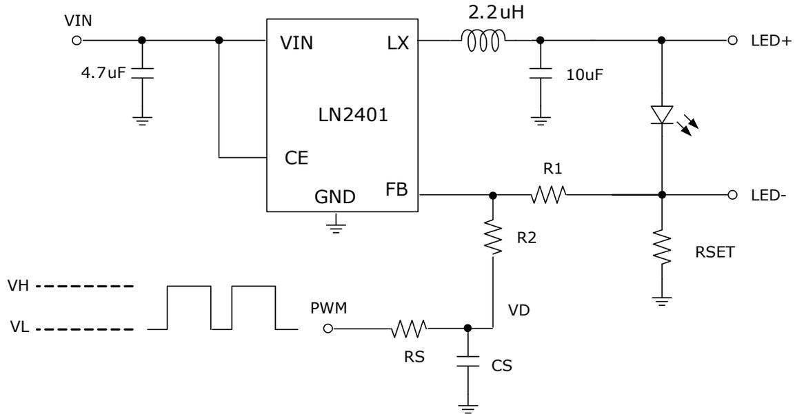
RS 和 CS 组成的低通滤波器将数字信号 PWM 转换为模拟信号 VD。
